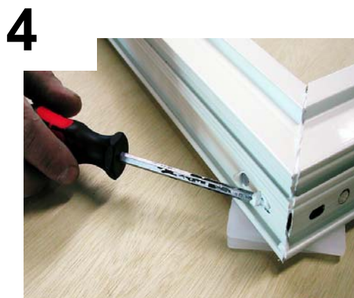
Profilene slås sammen med gummiklubbe, og skrues sammen med 4 mm umbrako. Pass på at tappene på vinkelen er kommet rett i hullene
